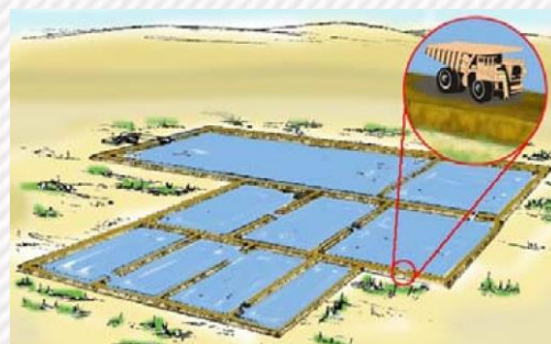
شکل 1: نمای شماتیکی و واقعی از حوضچه‌های تبخیری خورشیدی.
