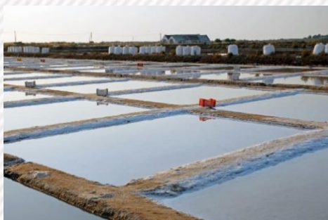
شکل 1: نمای شماتیکی و واقعی از حوضچه‌های تبخیری خورشیدی.
